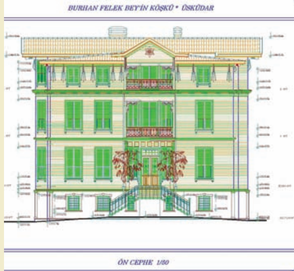
İhale kapsamında hazırlanan 1802 Ada 101 Parseldeki Burhan Felek Bey Köşkü'nün Restorasyon Projesine ait cephe çizimleri.
